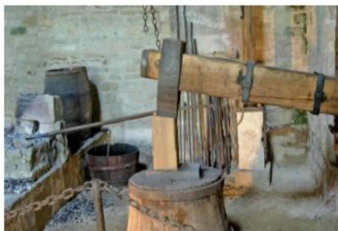
Les taillanderies, d'où sortaient des haches, des pioches, d'autres outils dépendaient du bon fonctionnement d'un martinet. Un martinet est encore en activité à Corcelles.
